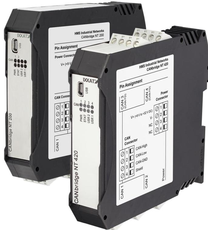
CANbridge NT には高速 CAN×2 ポートの CANbridge NT200 と、高速 CAN×4 ポート（そのうち 2 ポートは CAN FD として使用可）の CANbridge NT420 があります。CANbridge NT は、ビットレート変換、フレームフォーマット（11/29 ビット識別子）変換、ID 変換を行える CAN-CAN ゲートウェイです。NT420 では、上記の機能のほか、CAN FD->CAN へのデータ分割、CAN->CAN FD へのデータ多重化も行えます。
